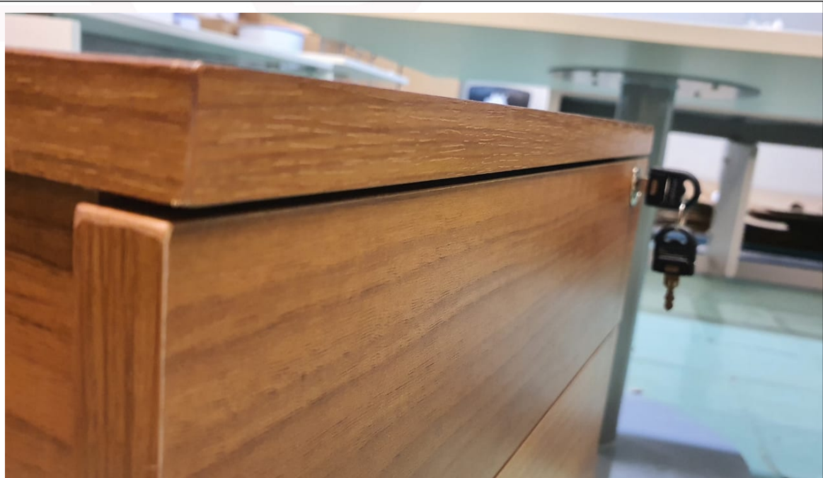
Imagem 02 – Detalhe da fita de borda com 1mm de espessura e pequeno desalinhamento do tampo com as gavetas
