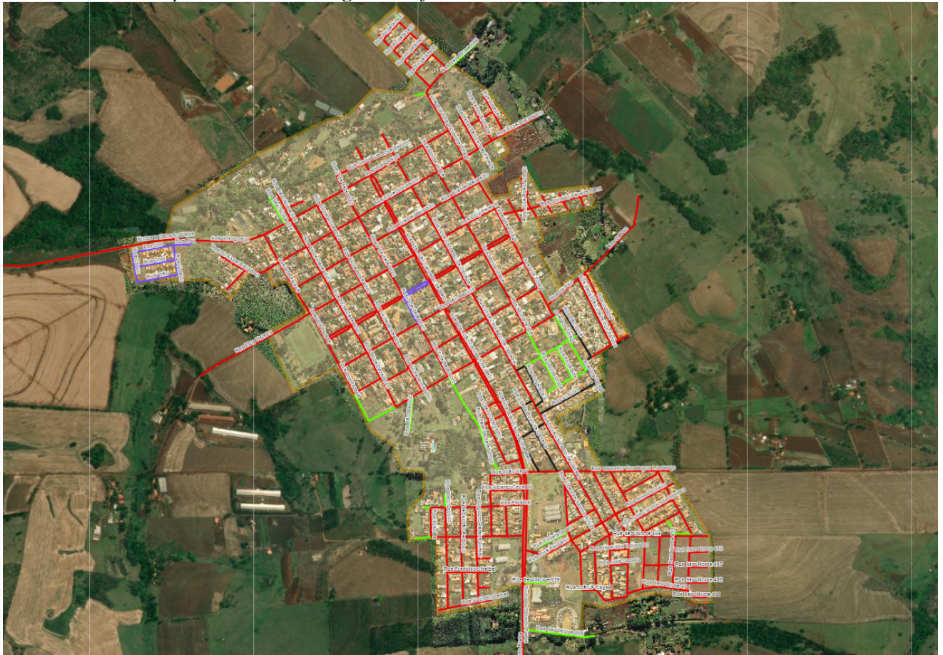
Figura 8 – Exemplo de foto georreferenciamento em município, com distinção entre ruas pavimentadas e não pavimentadas – Programa Asfalto Novo. Vida Nova – Estado do Paraná
