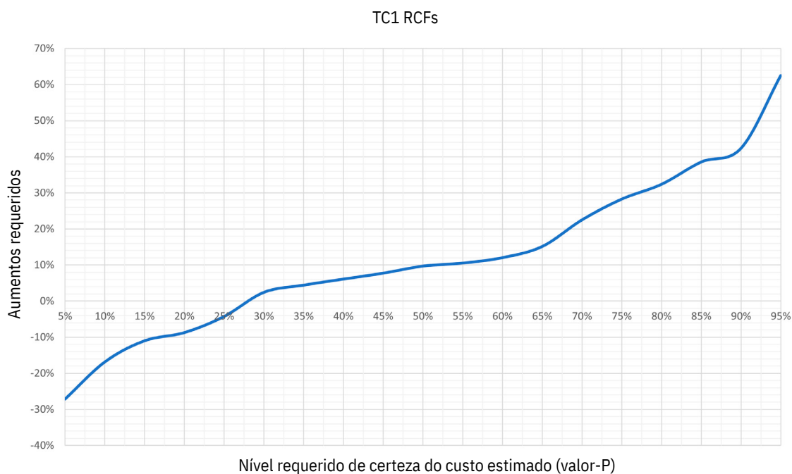
Figura 15: Curva de Classe de Referência para o desempenho real das rodovias na Irlanda 13
