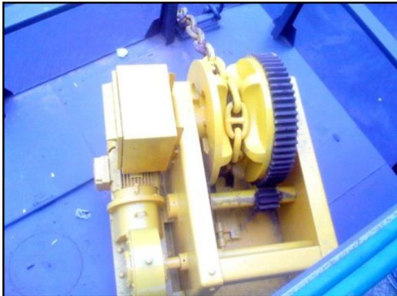
**Figura 49** – Molinete elétrico do sistema de fundeio do porto de Manaus
