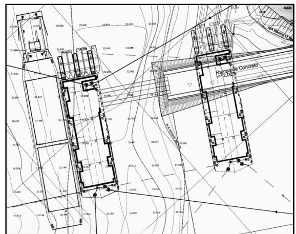
**Figura 48** – Linhas de ancoragem de um cais flutuante, na segunda solução de projeto
