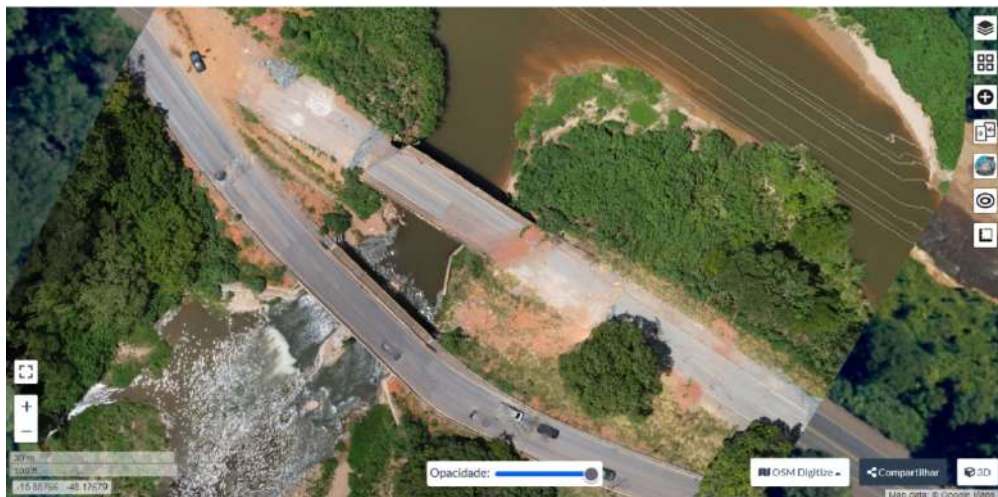
Figura 4 - Imagem de Drone com GSD de 2,44 cm mostrando a construção da ponte provisória.
