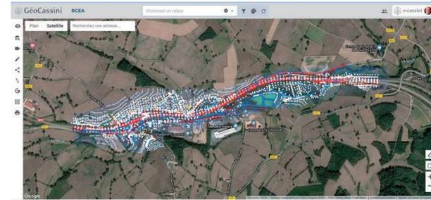
Exemplo de plano topográfico feito a partir de cobertura Lidar
