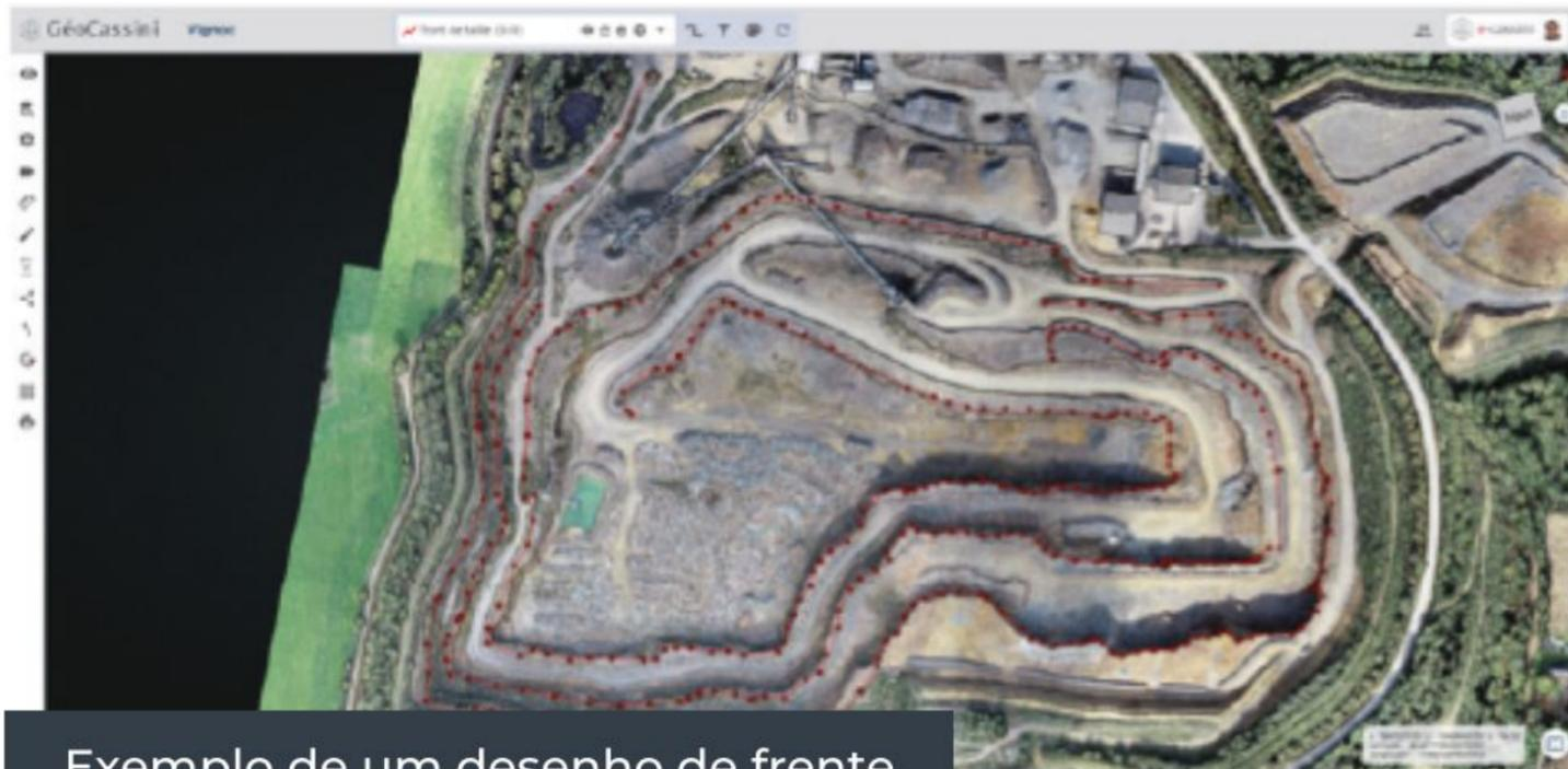
Exemplo de um desenho de frente de corte feito após uma cobertura Lidar
